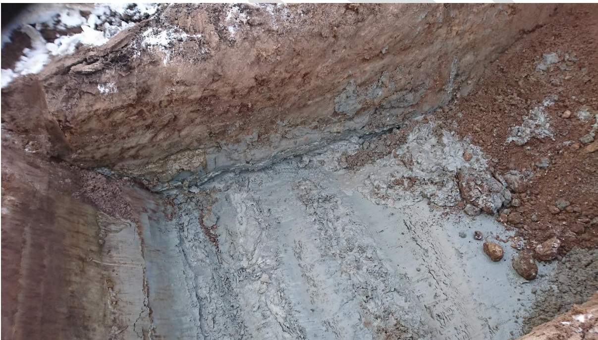
Bild 4; Provgrop grävd ned till lera. Leran är i många fall som här gråfärgad, men den kan ha andra färger såsom rödbrun, gulbrun och blågrå. Foto Loxia.
