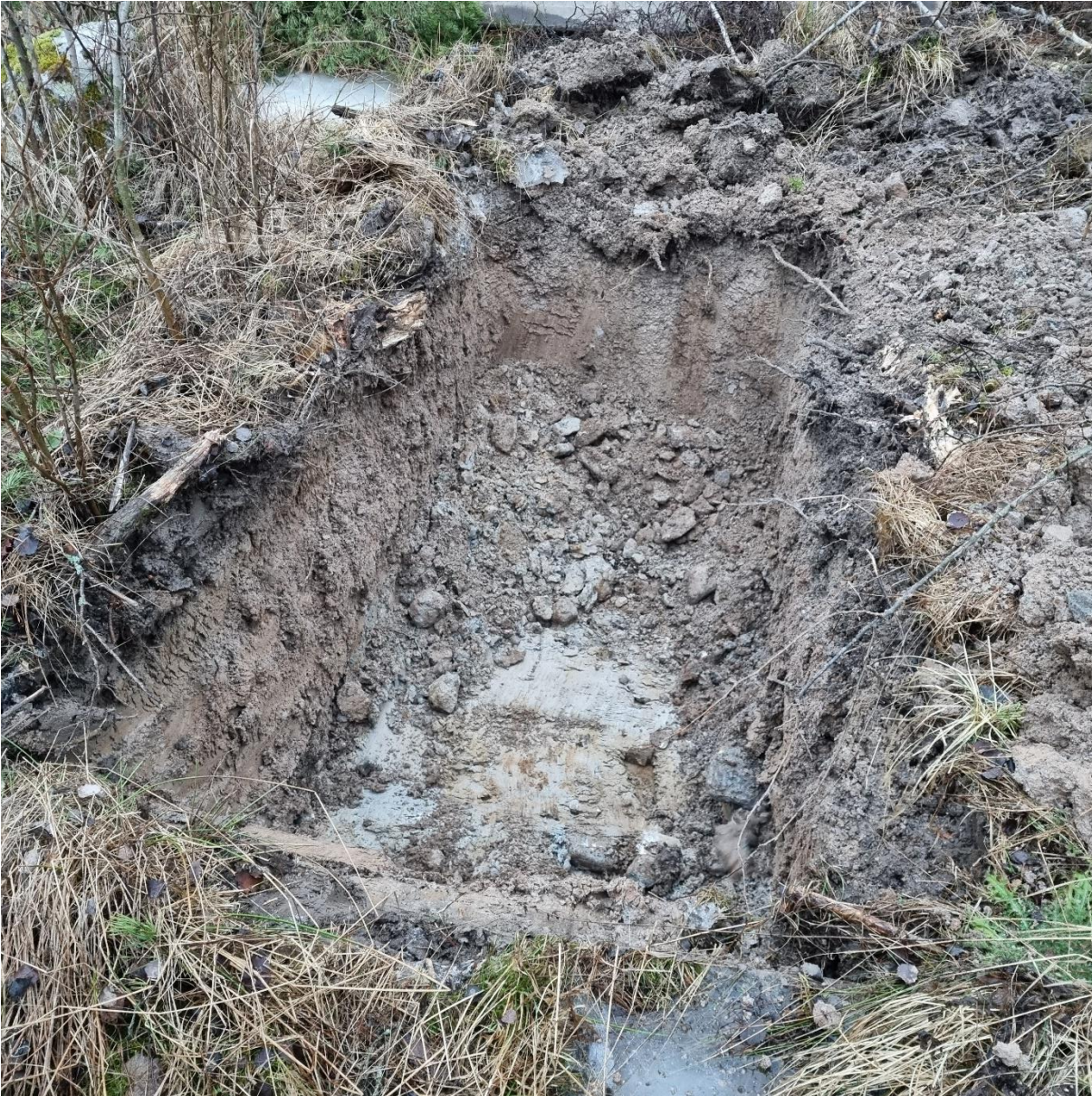
Bild 5; Provgrop i morän som utmärker sig av blandad kornsammansättning i många fall som här stort inslag av sten och block. Foto Loxia.
